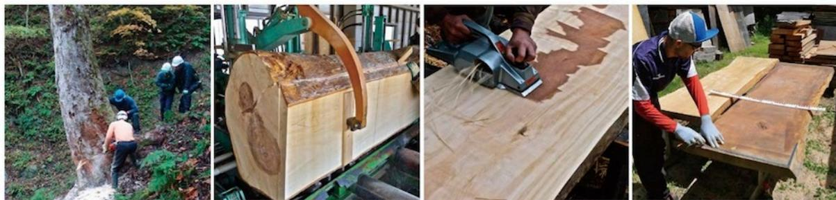
原木伐採・製材\_マテリアルトリートメント長期自然乾燥・養生ストック\_加工・仕上げ
